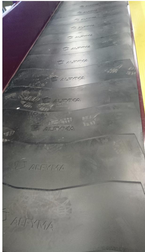
Los carruseles están formados por elementos estructurales estándares con soporte, con uno o varios módulos motorizados, módulo tensor, cadenas de transporte con ruedas de guiado, plataforma de transporte, revestimiento lateral y unidad de control.
